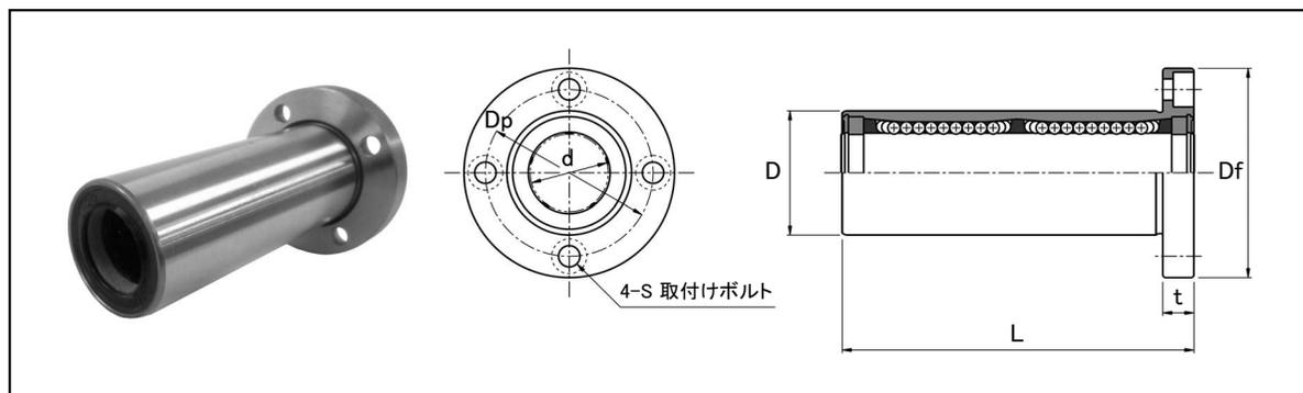
表：LFD-MF, MLFD-MF, ULFD-MF, UMLFD-MFシリーズ寸法表
